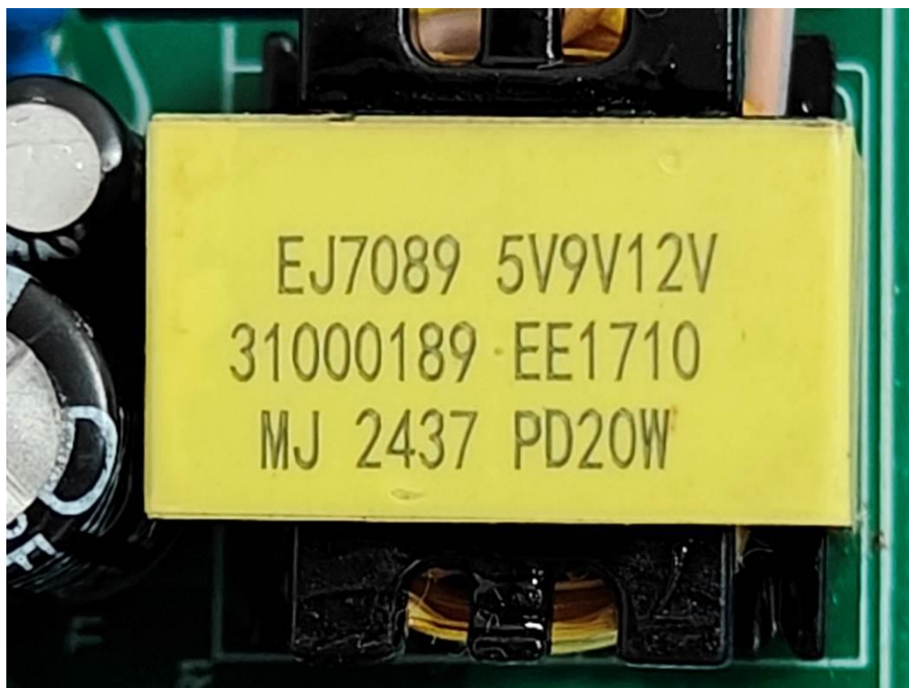
变压器标识 (型号: EE1710, “MJ” 代表制造商: 江西联迪有限公司)
